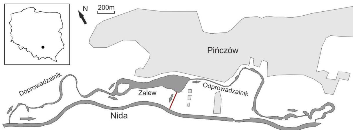
Fig.1. Ogólny schemat lokalizacji Zalewu Pińczowskiego wraz z doprowadzalnikiem i odprowadzalnikiem. Strzałki oznaczają kierunek przepływu wody. Czerwonym kolorem zaznaczono lokalizację dodatkowego kanału odprowadzającego zbudowanego w 2013 roku
