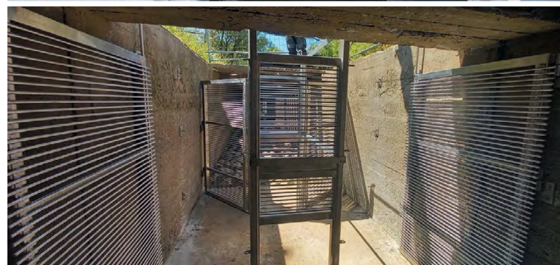
3 | (u góry) Riverwatcher Vaki – urządzenie do wizualnej rejestracji migracji ryb fot. Archiwum ZBE
